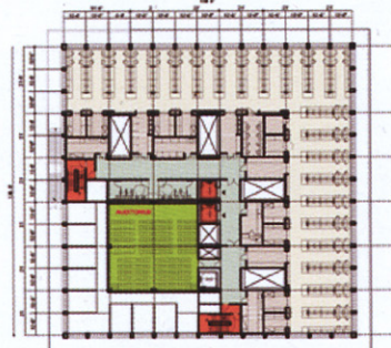
PLANTA SÉPTIMA: AUDITORIO LABORATORIOS, ESPACIOS DE APOYO
